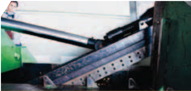
EL OPERADOR OPRIME la palanca hidráulica para aplastar los residuos.
