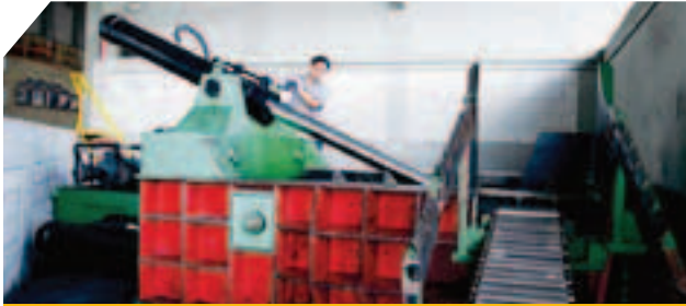
EN EL PROCESO, la hojalata comprimida adquiere la forma de un cubo.
