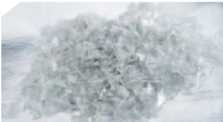
DESPUÉS DE RECIBIDO Y LAVADO, el plástico se muele y luce así antes de pasar a la etapa de fundición.
