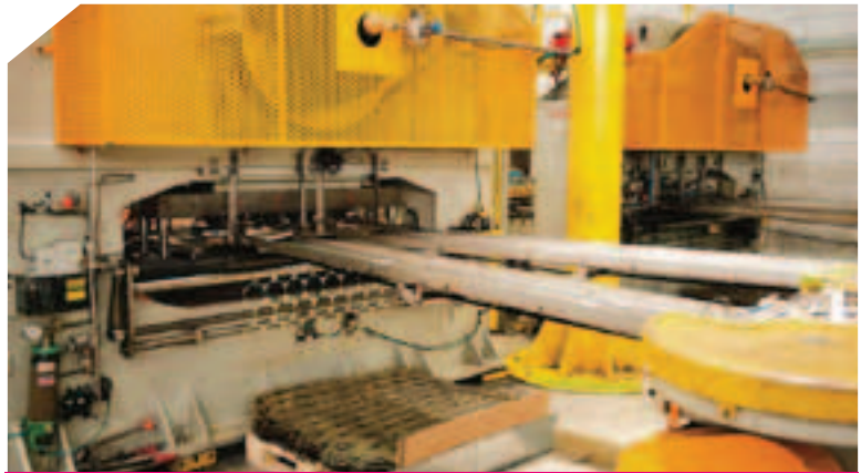
ENVASES COMECA CUENTA CON UN PROGRAMA DE CAPACITACIÓN para su personal y sus clientes, cuyo objetivo es aprender la disposición correcta de los residuos de hojalata. Esta es la máquina troqueladora de los abrefáciles.
